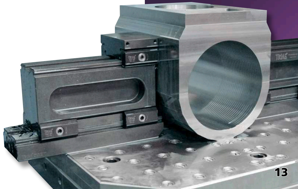
5-Achs Anwendung auf Monoblock 5-axis application on monoblock
