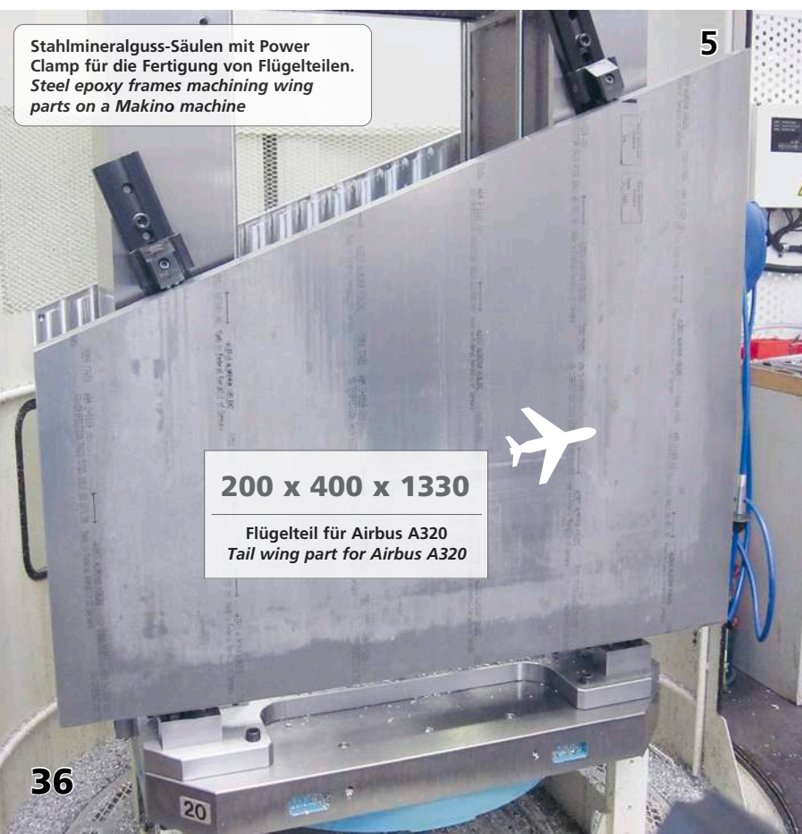
Chaotische Fertigung auf einem Mineralgussturm in Kreuzform. Mixed set up on cross epoxy tombstone.
